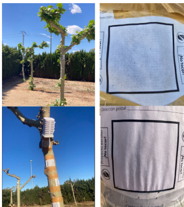
Figura 2. Sensores de papel pegados junto al sensor digital (protegido por una carcasa) y detalle del sensor con material adherido.
