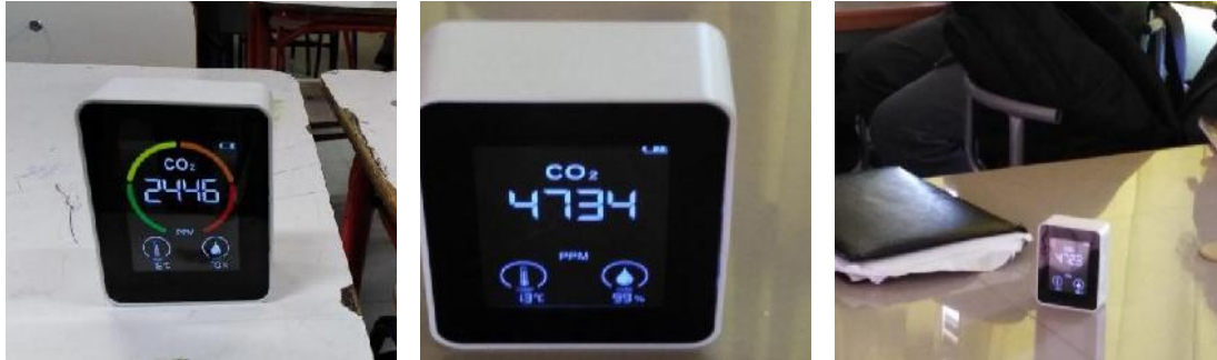
Foto 5: Medidor de la calidad de aire marcando en sala sin ventilación (foto tomada por Verónica Espinoza)
