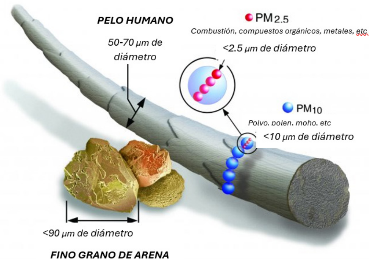
Figura 1. Comparativa del tamaño de material particulado PM 10 y PM 2.5 con un pelo humano y un grano de arena. Adaptada de Particulate Matter (PM) Basics | US EPA, 2025.
