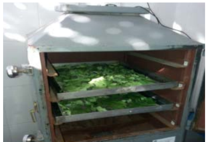
Figura N° 2. Estufa de secado con hojas de Mesembryantum crystallinum .
