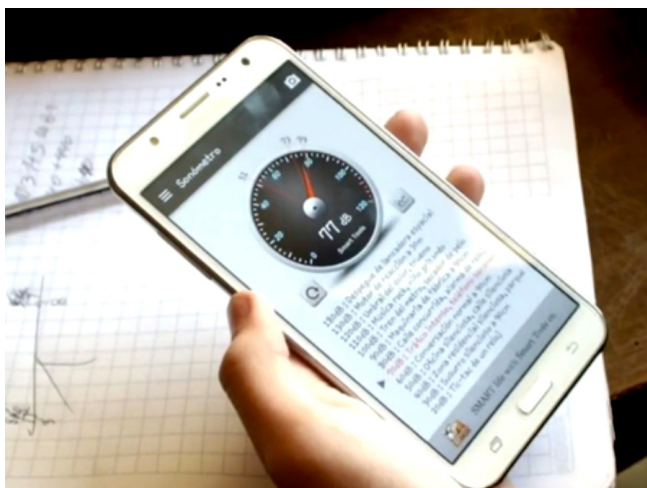
Figura N° 1. Celular calibrado con aplicación de sonómetro utilizado para medición.
