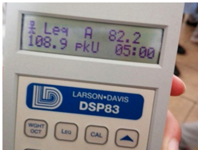
Figura N°2. Sonómetro Calibrado utilizado en las mediciones.
